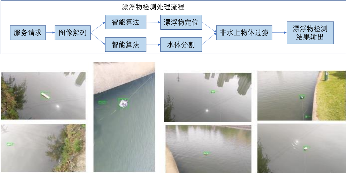
图 4.1-5 漂浮物检测流程与示例
